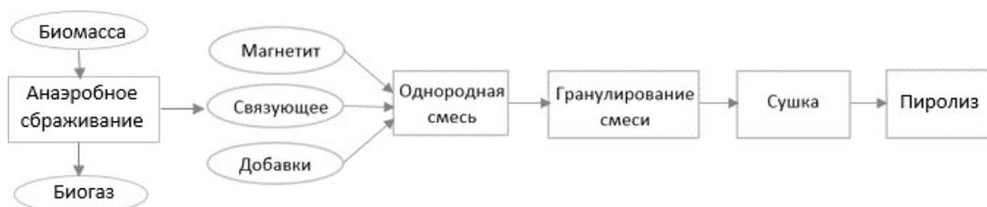
Рисунок 3 – Функциональная схема получения магнитного углеродного нефтесорбента
