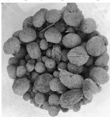
*Рисунок 4 – Формованные магнитные гранулы*
