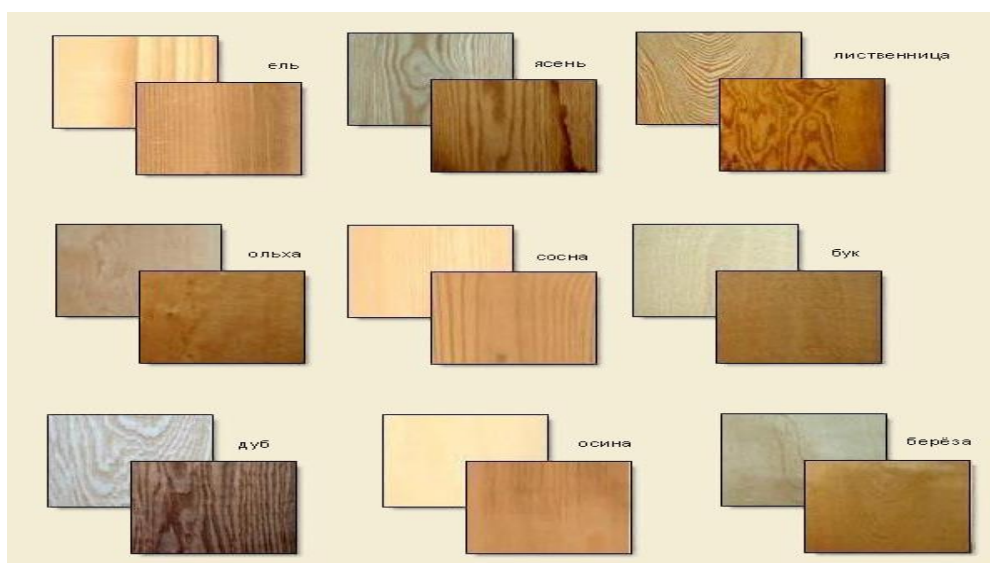
Рисунок 1 – Результаты термообработки различных пород древесины [3]
