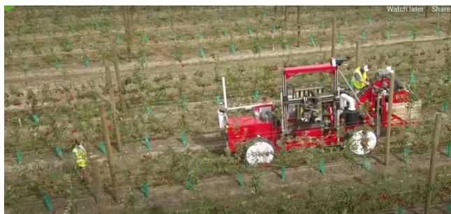
Рисунок 3 - Робот сбора яблок (США) [2]
