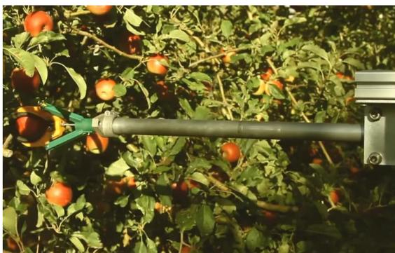
Рисунок 4 – Рука-манипулятор робота от компании «FRRobotics» (США)
