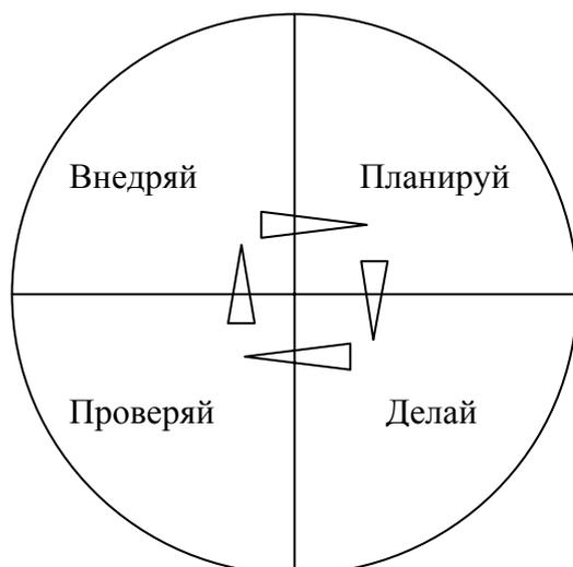
Рис. 2. Схема цикла Деминга<sup>5</sup>
